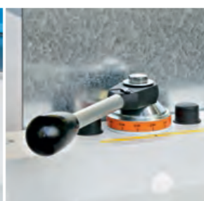
Werkzeugfrei justierbare Schnittspalteinstellung
